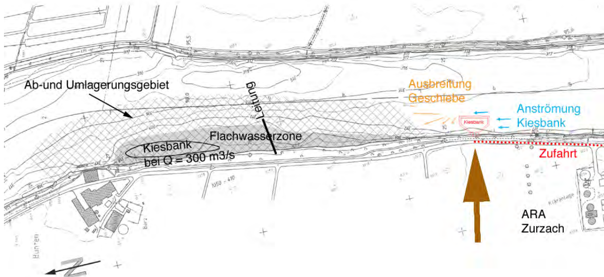
Bild 8.8 Lage der Schüttstelle Zurzach (brauner Pfeil) und des Ab- und Umlagerungsgebietes des Schüttmaterials. Massstab 1 : 5'000.
