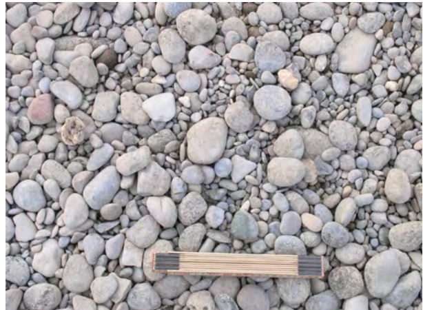
Bild 8.15 Während dem Hochwasser vom August 2005 hat sich aus den drei geschütteten Kiesbänken eine langgezogene Kiesbank gebildet, die die grobkörnige Sohle der Flachwasserzone teilweise überdeckte.
