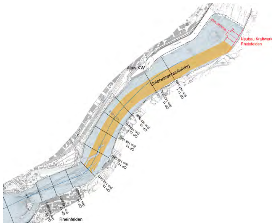
Bild 6.13 Lage des alten und neuen Kraftwerks Rheinfelden mit der ausgehobenen Unterwasserrinne (gelbe Fläche).
